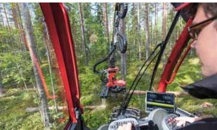
В новой просторной, шумоизолированной кабине увеличены окна, обеспечивая идеальную обзорность вперед-вниз, вперед-вверх и назад.
