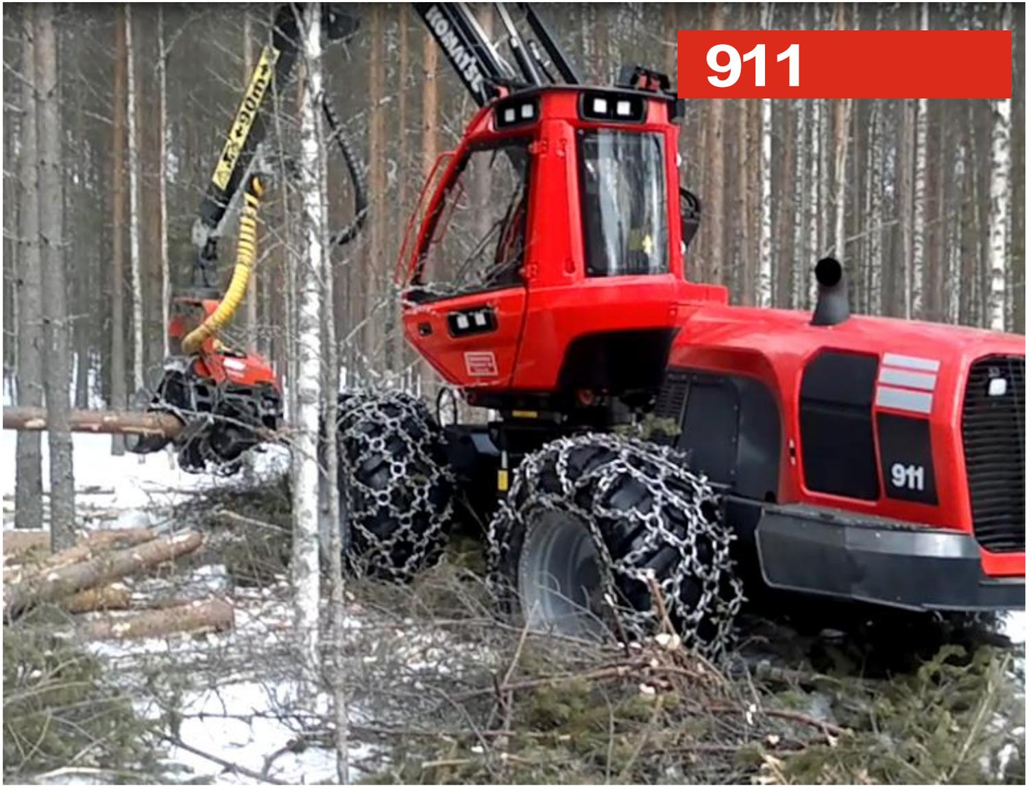
ном уровне. Кроме того, возможность поворота кабины на 360 градусов позволяет заготавливать больший объем древесины на одном месте, что повышает производительность трелевки/вывозки леса. Как обычно для машин Komatsu, эта модель отличается чрезвычайной устойчивостью благодаря уникальному расположению манипулятора и соединению цилиндров наклона и моста с независимой подвеской.
