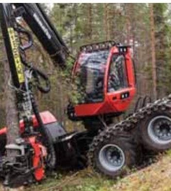
Выравнивание кабины позволяет оператору всегда сидеть прямо в горизонтальном удобном положении, вне зависимости от наклона машины, и не напрягать мышцы тела, чтобы занять удобное рабочее положение.
