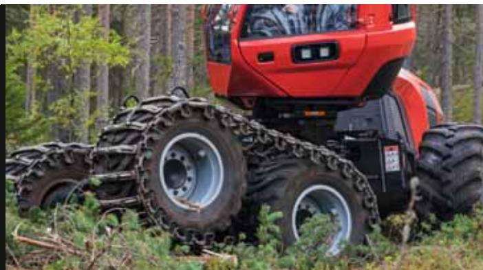
Уникальная tandemная тедежка портального типа Komatsu Comfort Bogie обеспечивает непревзойденные устойчивость, дорожный просвет и проходимость харвестера.
