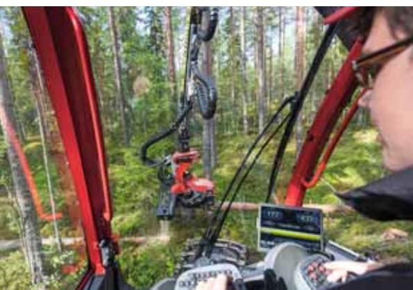
В новой просторной, шумоизолированной кабине увеличены окна, обеспечивая идеальную обзорность вперед-вниз, вперед-вверх и назад.
