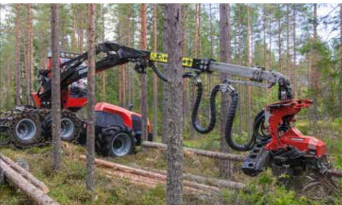
Меньше перемещений, объемнее пачки сортиментов. Рабочая зона 360 градусов позволяет заготавливать большой объем древесины на одном месте, что также повышает производительность трелевки/вывозки леса.
