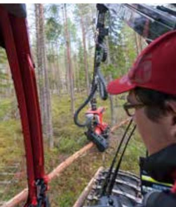
Всегда идеальная обзорность. Благодаря тому, что манипулятор расположен на одной поворотной платформе с кабиной, оператору гарантирована идеальная обзорность агрегата, при работе как рядом с машиной, так и на большом вылете стрелы манипулятора.
