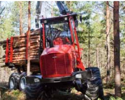
Конструкция модели 835 базируется на собственной платформе с максимальным учетом требований маневренности и низкого давления на почву.
