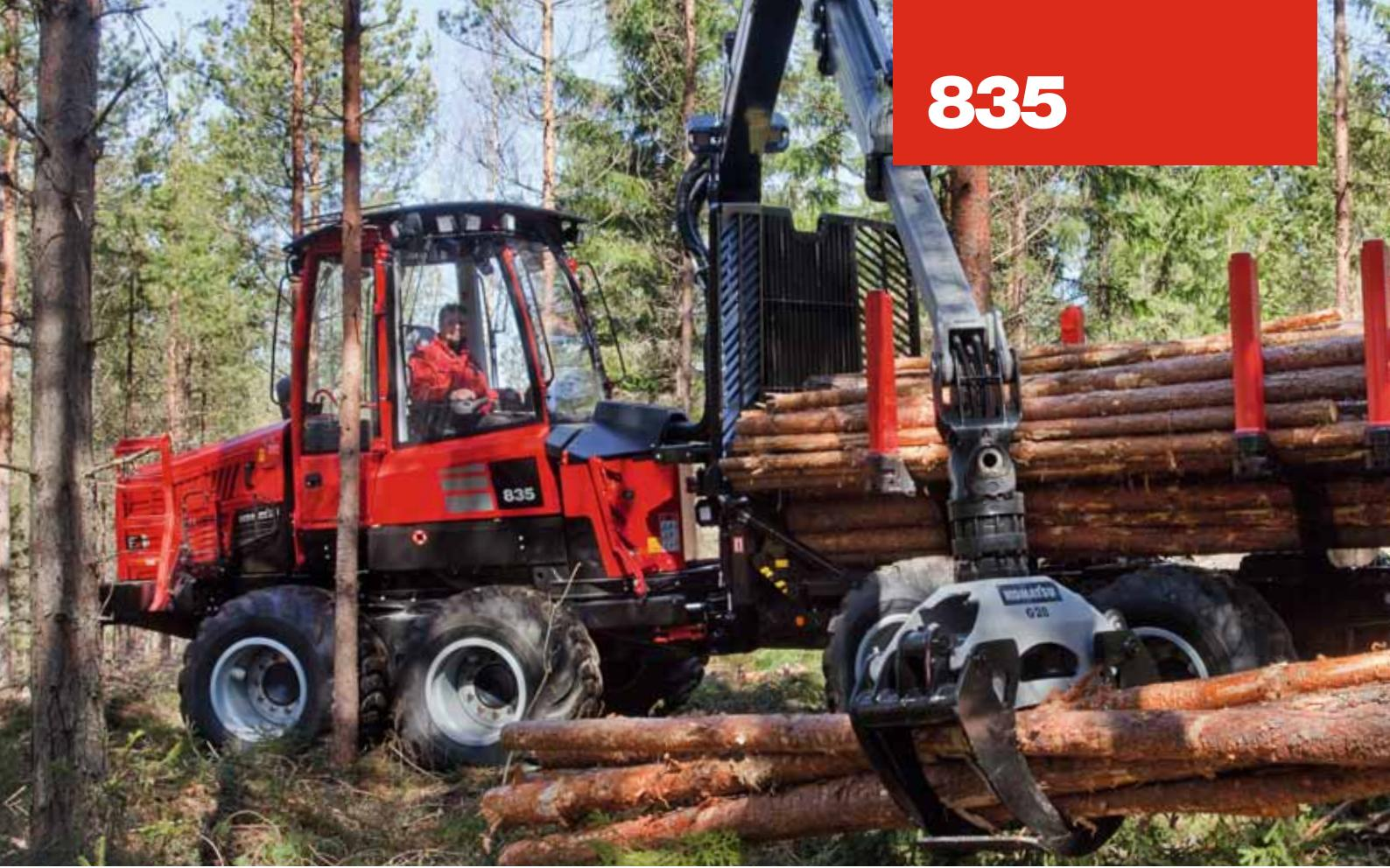
А благодаря новой рамной конструкции, оптимизированной под весовую нагрузку, значительно улучшена способность форвардера преодолевать препятствия.
