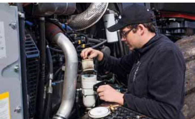
Новые преимущества в отношении сервиса – от более удобного доступа к фильтрам и отдельного отверстия для заливки дизтоплива и гидравлического масла до кассетной системы для более быстрой регулировки клапанов.
