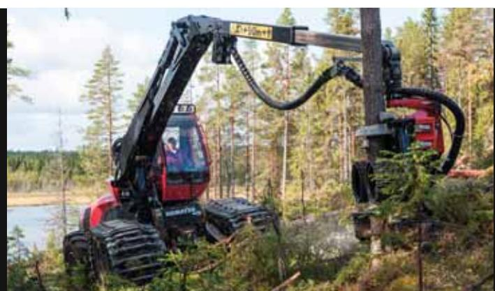
Уникальное решение, сочетающее расположенный в средней части машины манипулятор, во-первых, и соединение цилиндров наклона и моста с независимой подвеской, во-вторых, обеспечивает превосходную устойчивость.
