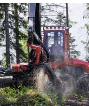
Всегда идеальная обзорность Благодаря тому, что манипулятор расположен рядом с кабиной, оператору гарантирована идеальная обзорность агрегата, как при ближней работе, так и при большом вылете стрелы манипулятора.
