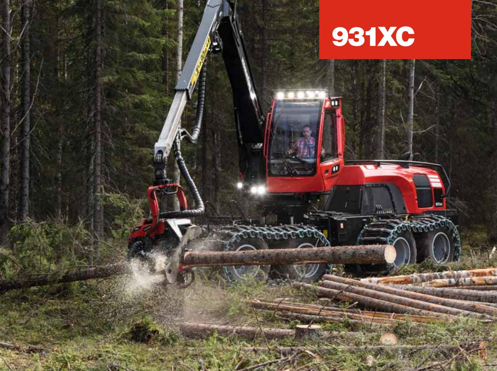
в течение нескольких десятков лет доказала свою максимальную эффективность. В придачу к качающейся задней оси Komatsu 931ХС оснащен тележкой, смонтированной на качающейся оси. Это обуславливает уникальные ходовые качества, так как машина повторяет все неровности поверхности непревзойденно точно. Манипулятор с высоким усилием поворота и высокий дорожный просвет машины – это незаменимые качества для работы на местности с самыми сложными условиями.
