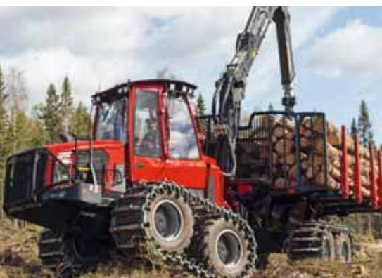
Оптимально сбалансированная тандемная тележка портального типа Komatsu Comfort обеспечивает превосходные дорожный просвет и проходимость машины.
