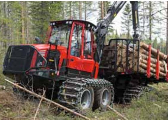
Специальное решение (гидро-статической) трансмиссии с базовым тяговым усилием 214 кН и ее уникально слаженное взаимодействие с системой управления и двигателем обеспечивают высочайшую эффективность.
