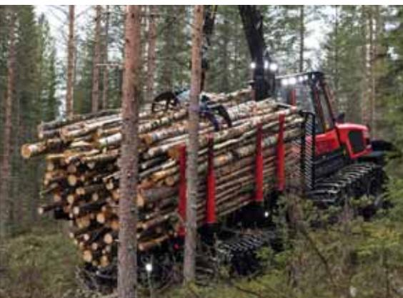
Манипулятор отличается большим радиусом действия и высокой нетто-грузоподъемностью, надежным решением колонны манипулятора и протяжки шлангов, а также оснащен Combi-стрелой. Наклоняемая колонна манипулятора (опция) для эффективной погрузки на сложной местности.
