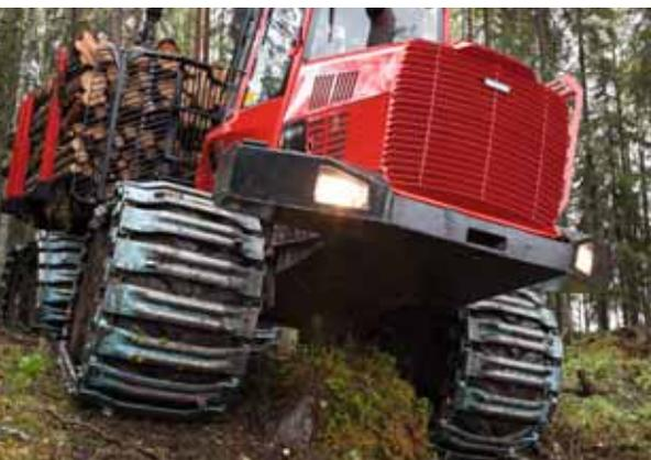
Колеса диаметром 26,5 дюймов/67,3 см обеспечивают большее тяговое усилие и увеличенный дорожный просвет. На обоих колесах предусмотрено место для цепей или широких гусениц.
