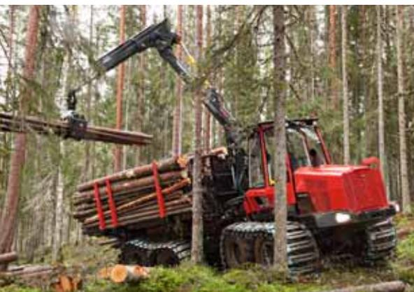
Конструкция модели 845 базируется на собственной платформе с максимальным учетом требований маневренности и низкого давления на почву.
