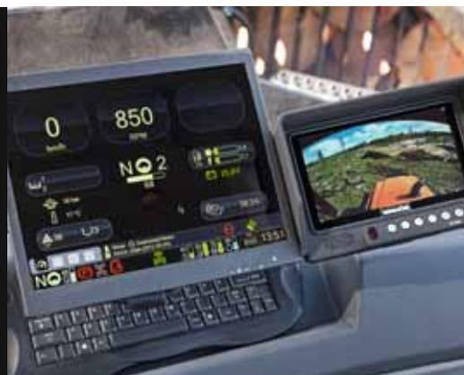
Модель 845 оснащена самой современной системой управления MaxiExplorer. В качестве опции предлагается MaxiFleet, первая в мире система управления и координации машинного лесозаготовительного парка.
