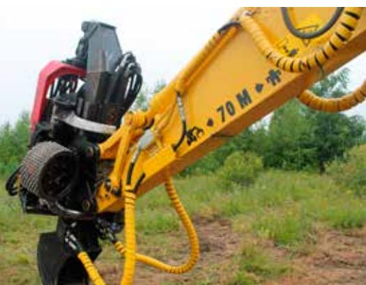
Стрела оснащена специальным адаптером, увеличивающим её вылет. Четыре специальные гидравлические трубы закреплены болтами в нижней части наконечника стрелы экскаватора и оснащены защитной скобой, снижающей риск повреждения. Точки смазки перенесены в легкодоступные места, что упрощает обслуживание.
