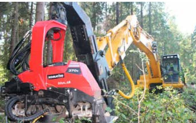
Стрела-ковш дает дополнительную функциональность – возможность оператору поднимать машину, корчевать пни и, кроме того, удобно складывать агрегат в транспортное положение.
