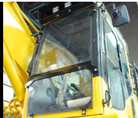
Переднее стекло – безопасное поликарбонатное стекло толщиной в 19 мм, чтобы защитить оператора от обрыва цепи или от других механических воздействий.
