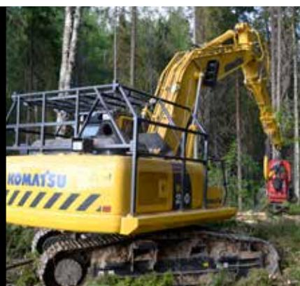
Прочная и продуманная защита капота и отсеков двигателя снижает риски повреждения и попадания щепы, листьев и отходов из воздухозаборников в отсек двигателя, что является дополнительной мерой пожарной безопасности.
